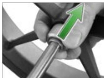
Lösen und Befestigen der Räder
