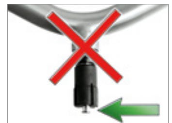
Spreizdübel zu weit eingedreht
