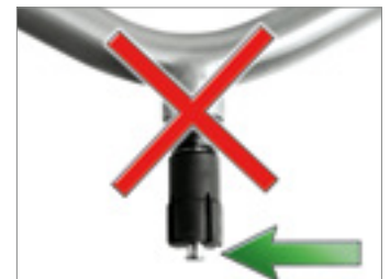
Spreizdübel zu weit eingedreht
