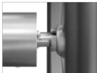
Antriebsrad in Freilauffunktion arretiert
